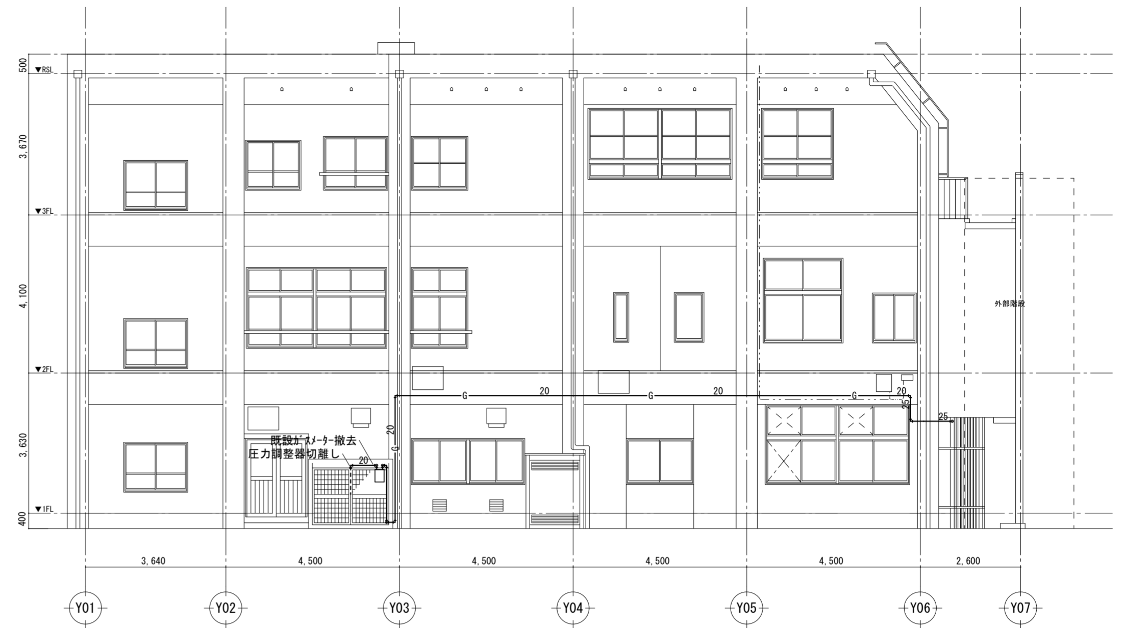
北立面図 SC=1/100 (改修前) (注記) 1. 実線部分は撤去処分を示す。 2. 既設ガス配管撤去に伴う支持金物撤去跡の穴埋め (モルタル詰め程度)、ケチッパ程度程度の塗装補修を行うこと。
